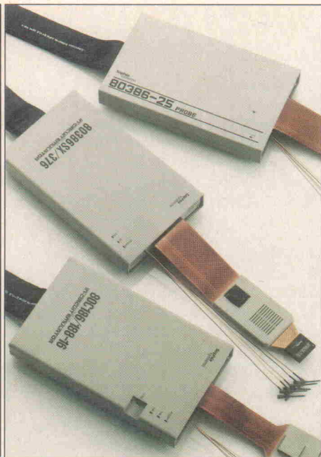
Das Sophia-SA98-System emuliert 16- und 32-Bit-Prozessoren bis 25 MHz.
