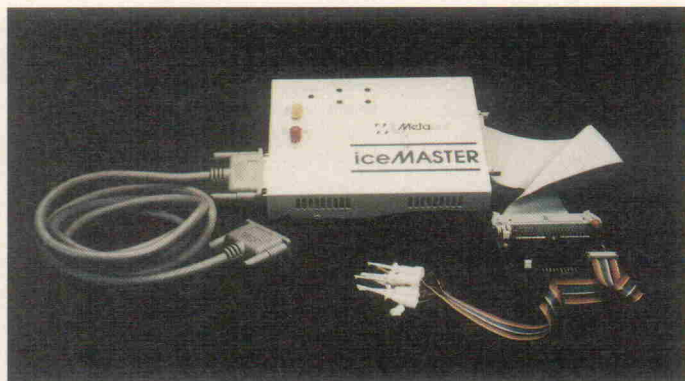
Der iceMaster von Allmos ist für alle Controller der 8051-, 68HC11- und COP8-Familien konfigurierbar.
